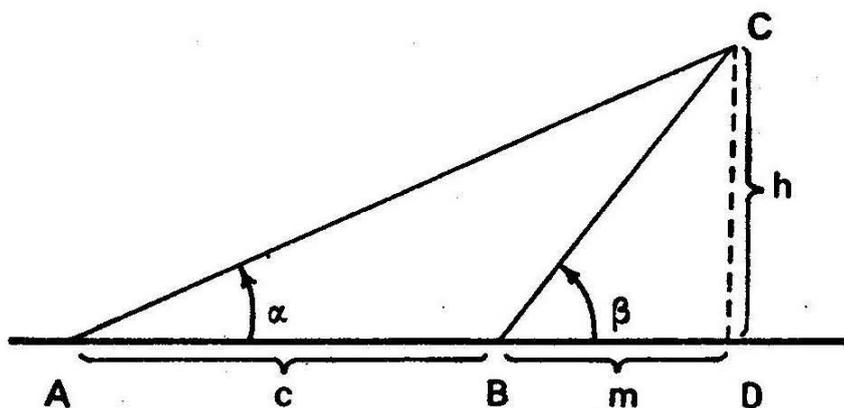
*Calcular a altura de uma torre, por meio de medições efectuadas no solo, em plano horizontal, supondo que a base da torre é visível, mas não acessível para medições.*
